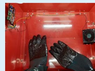
L'enceinte fermée était équipée d'un système d'acquisition LabVIEW. Le programme gérait la ventilation de l'enceinte en plus d'acquérir les données provenant des quatre capteurs. À la fin de chaque acquisition, le programme enregistrait les données dans un fichier Excel et les affichait sous forme de graphique.
